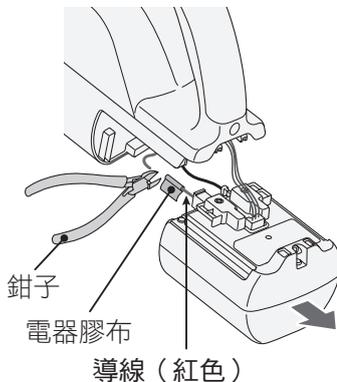
**3** 用鉗子等工具，逐一將所有其他的導線，在距電池約2cm處切斷，並用乙烯基膠帶纏繞進行絕緣
